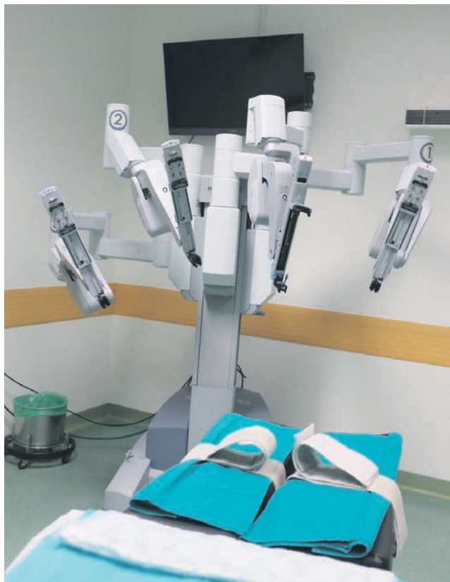
Robotske roke, ki preko vodil in oprijemalk posežejo v človeško telo.
