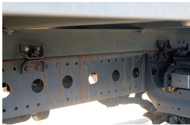
Na vozilu so manjkali trije vijaki za pričvrstitev kesona. (Foto: PU Celje)
