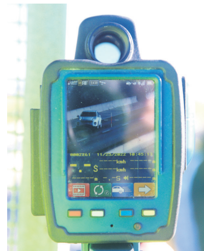
Naprava, ki natančno izmeri, ali je bila med vozili ustrezna varnostna razdalja.
