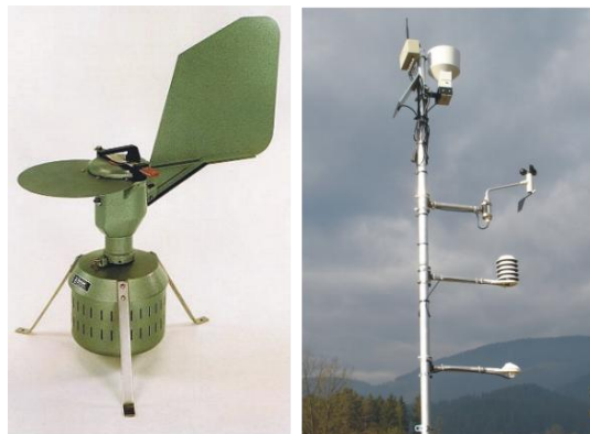
Slika 11: Volumetrični lovilec spor (levo); ADCON agrometeorološka postaja (desno)
