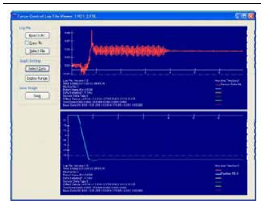
Slika 4. Grafični prikaz podatkov senzorja sile v programskem okolju RTTool-Box2 [1]
