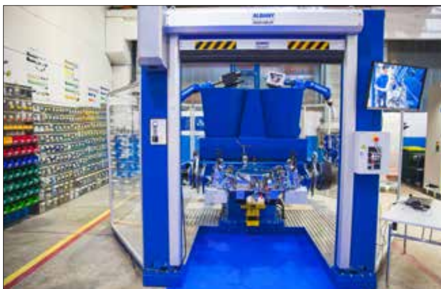
Robotska varilna celica z industrijskima robotoma Motoman, pritrjenima na dvo položajno pozicionirno mizo
