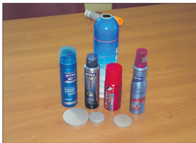
Rondelice so okrogle ploščice iz aluminija, različnih premerov in debelin (v ospredju), ki se uporabljajo za proizvodnjo aluminijastih tub in doz v farmacevtski in prehrabeni industriji ter v kozmetiki.
