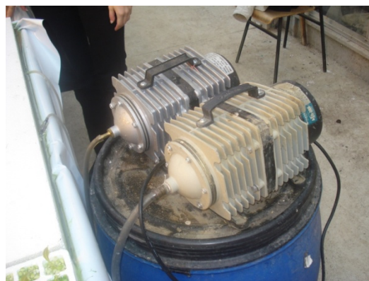
a) Gojivne plošče na plavajočem sistemu, b) Kompresor za dovajanje zraka.
