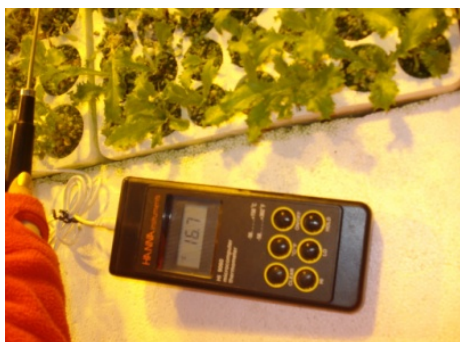
Slika 4: a) konduktometer za merjenje EC in merjenje temperature raztopine, b) pH meter, c) naprava za merjenje temperature zraka.
