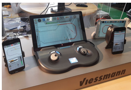
Viessmannov »commander 2« v kombinaciji s tabličnim računalnikom ali pametnim telefonom tvori zmogljivo digitalno centralo, ki podpira protokole NMRA-DCC in Marklinov sistem (Motorolin stari oziroma novi in MFX).
