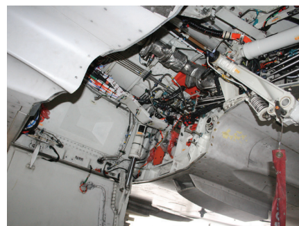
Jašek glavnega podvozja in pogled na zadnjo stran s cevnicami napeljavami (Foto: Mitja Maruško)
