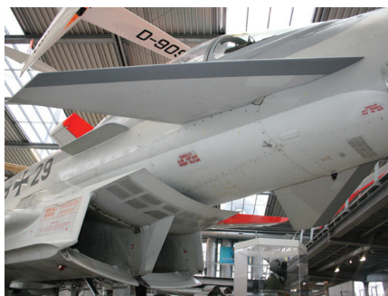
Vstopniki zraka in sprednji spodnji del trupa s krmilnimi površinami (Foto: Mitja Maruško)
