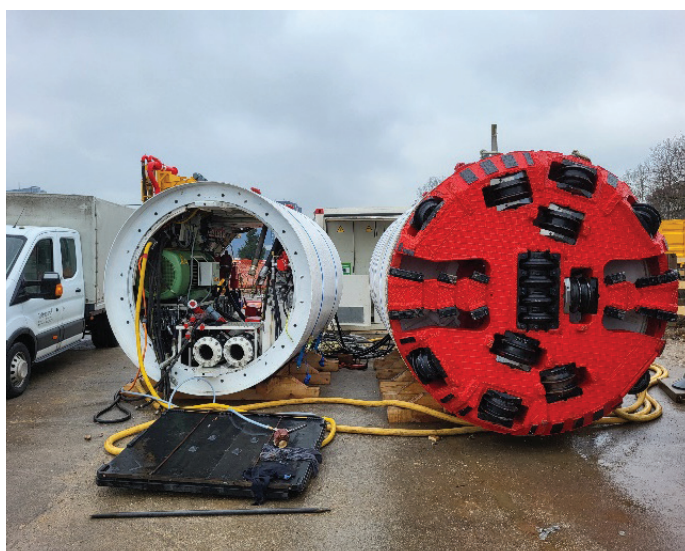
Sliki 6 in 7. Priprava vrtilne glave in separacije pred izvedbo mikrotunela.
