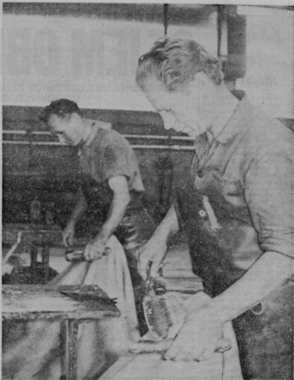
Verjeli ali ne, toda JOŽE URBANC in STANKO DREV iz Tovarne usnja v Šošanju sta edina delavca v Evropi, ki še ročno »folcata« goveje kože, iz katerih izdelujejo specialne jermenske krupone in likanec. Zaradi vrhunske kvalitete, ki jo pri teh izdelkih dosegajo, je potrebno; da se struganje kož opravi na klasičen, ročen način. Od nekaj številih »folcarjev« sta ostala sama, ko se šihl za šihloma sklanjata preko lesenega kozla pritiskajoč s trebuhom na spolzko kožo...
