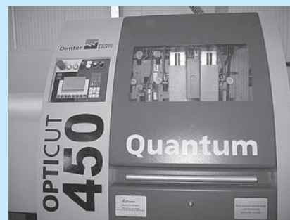
□ Najhitrejši optimirni čelilnik na svetu Dimter OptiCut 450 Quantum
