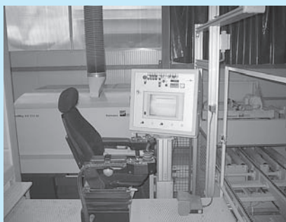
□ Večlistni krožni žagalni stroj Reimann ProfiRip KR 310 M s komandnim pultom za optimiranje vzdolžnega razžaganja
