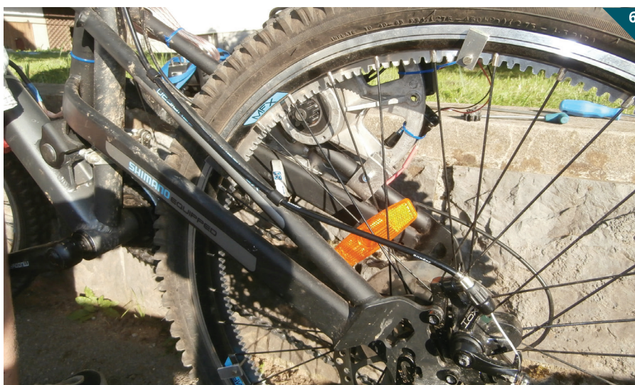
Zadnje kolo z nameščenim notranjim zobnikom in elektromotorjem
