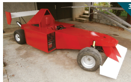
Dirkalnik po predelavi z novo oblikovanim sprednjim delom in primernejšimi kolesi
