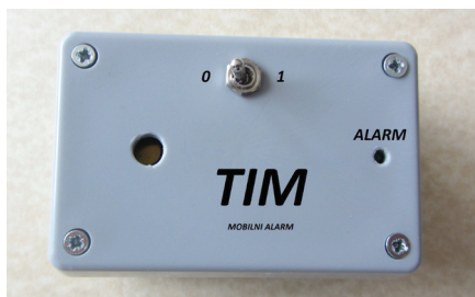
Mobilna alarmna naprava – daljineček spremlja alarme z več senzorskih enot.
