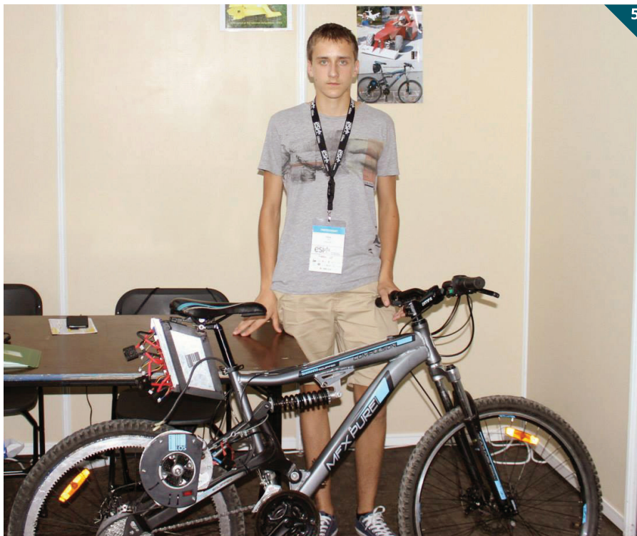
Na prireditvi Expo Science International v Belgiji se je Ožbej predstavil z izboljšano različico električnega kolesa, ki ima pod sedežem jeklen nosilec za več baterij. Pogon z vgrajenim ventilatorjem za dodatno hlajenje je pokrit s ploščo iz aluminijaste pločevine. (Vir: https://www.facebook.com/ESI2015?ref=ts&fref=ts )
