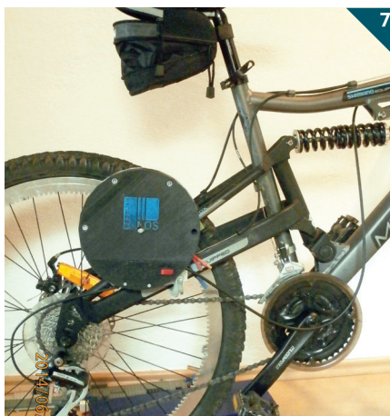
Osnovna oblika kolesa s pokrovom pogona, natisnjenim s 3D-tiskalnikom. Pod sedežem je torbica za shranjevanje baterij.
