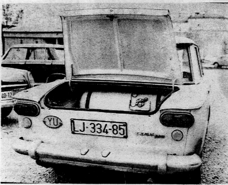
V PRTLJAŽNIKU — Rezervoar z odjemalnikom za utekočinjeni propan — butan, nameščen v prtljažniku.
