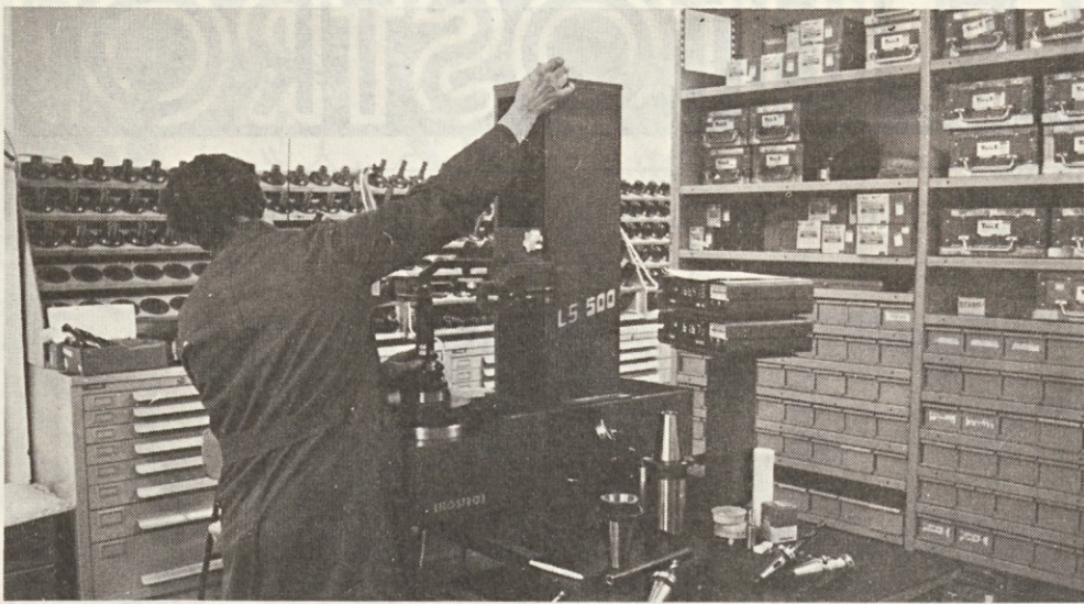
Ob nabavi novih strojev smo morali urediti tudi novo nastavljalnico orodij, v kateri prednastavljamo orodja za CNC rezkalne stroje in stružnice. Večino vpenjalnega orodja smo izdelali sami po lastnem sistemu, prav tako tudi prednastavno napravo LS 500, ki je na sliki in je plod lastnega znanja. (Foto: T. Š.)
