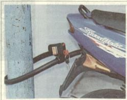
Učinkovita pogruntavščina: v zadku vgrajena veriga iz valjčastih členkov varuje skuter pred krajo.
