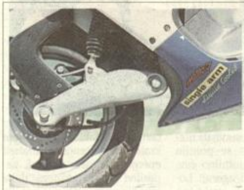
Prednje vzmetenje z enoročno nihajko, imenovano Single Arm, dobro kroti učinek posedanja med zaviranjem.
