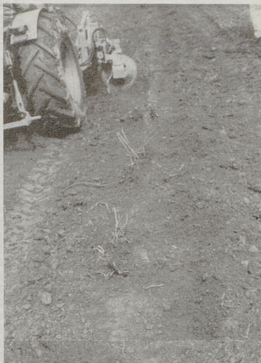
Diskovni odoranalnik – osipalnik iz garniture Fischer lahko v hmeljišču zelo natančno odkoplje – odorje vsako rastlino tudi v vrsti z drogovi. Z njim rastline tudi osipajo. Vse premontaže v sklopu garniture Fischer so zelo enostavne in hitre.
