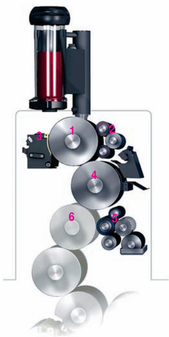
Slika 4. Barvilni sestav Anicolor: 1 – rastrski valj, 2 – sestav treh valjev za doseganje optimalnega ravnovesja tiskarske barva-vlažilna raztopina in čiščenje, 3 – zaprt sestav z rakiem, 4 – barvilni valj, 5 – slojni alkoholni vlažilni sestav Alcolor, 6 – ploščni valj.
