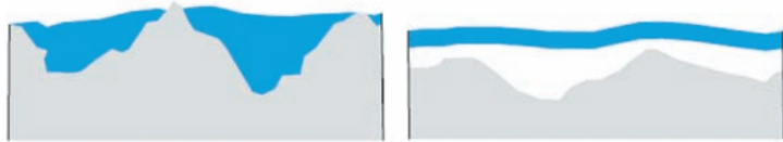
Slika 7. Navzemanje tiskarske barve na nepremazanem (levo) in premazanem papirju (desno).
