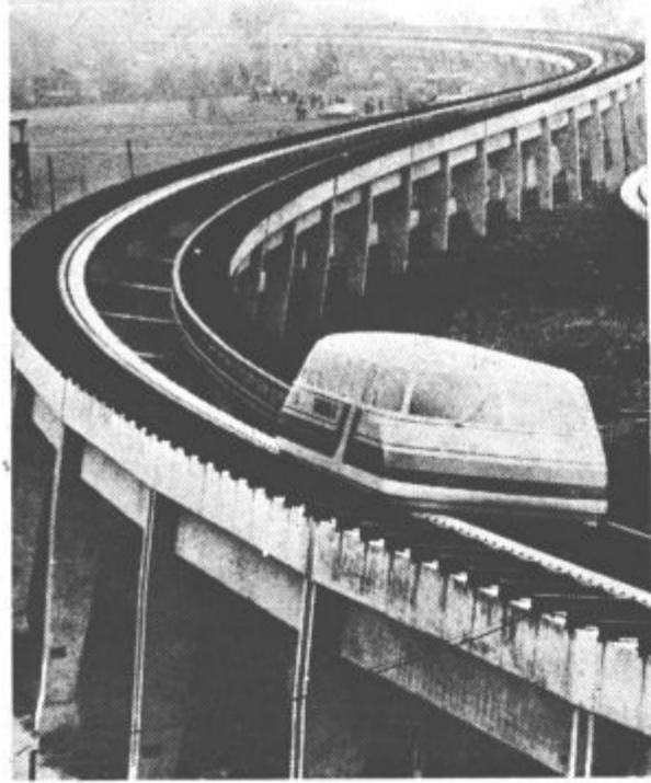
POSKUSI Z ŽELEZNICO PRIHODNOSTI – V Nemčiji delajo poskuse z novima vrstama železnice – elektromagnetično in elektrodinamično. V obeh primerih gre za vozilo brez koles, pri katerem bi vagoni drsili po posebnih tirih – na močnem magnetnem polju. Trenje bi bilo minimalno in bi se poleg popolne varnosti dosegale tudi velike hitrosti. Na sliki: Pogled na del poskusne steze v bližini Muenchna, po kateri drsi vagon „Transrapid 04“, ki lebdi na magnetni blazini.
