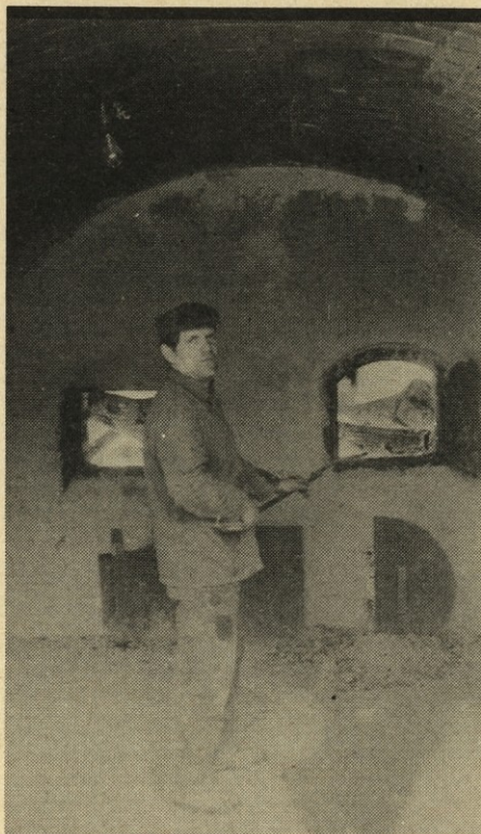
Juro Komljen ob pričetku ponovnega kurjenja v krožni peči za žganje opeke na opekarni tozđ GRAMAT po končanem remontu. (foto: A. Bregant)
