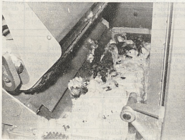
Zanetek požara je nastal v dovajalnem delu mikalnika št. 21, ker so se navila bombažna vlakna okoli kovinskega valja in drgnila ob zaščitno pločevino nad trgalnim valjem. Na fotografiji so še dobro vidna ožgana bombažna vlakna
