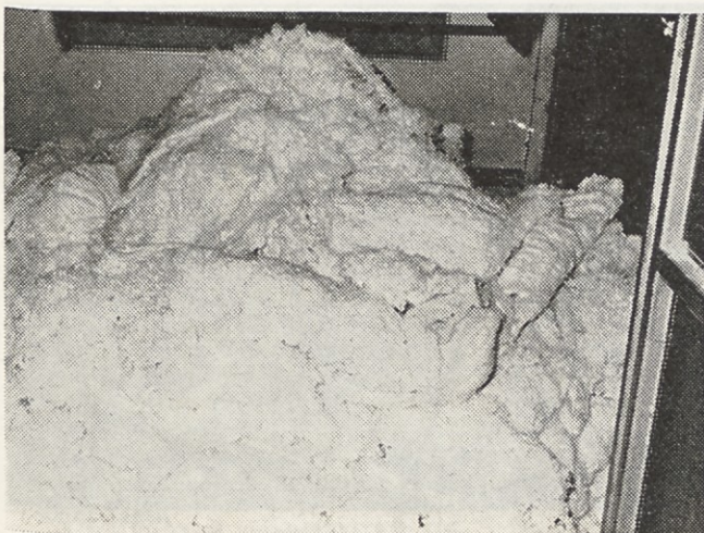
Po odsesalni cevi je zanesel zračni vlek iskre v prašni filter, kjer so zgorele nylon mreže in bombažni odpadki
