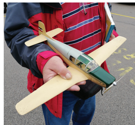
Ročno izdelana maketa v merilu 1 : 25 je ravno dovolj velika, da je bilo na njej mogoče nazorno prikazati vse najpomembnejše sestavne dele. (Foto: Jože Čuden)
