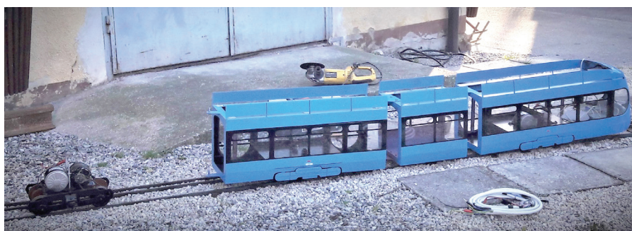
Eno od motornih podvozij modela TMK 2200
