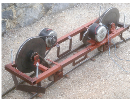
Podvozje modela dubrovniškega tramvaja. Lepo se vidita oba motorja in vztrajnika.
