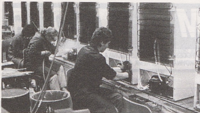
Nov način varjenja je prinesel ob boljših delovnih pogojih tudi znatno boljšo kakovost; sedaj varijo na letvstah tekočih trakovih, kar je izboljšalo tesnenje za okroglih sto odstotkov.
