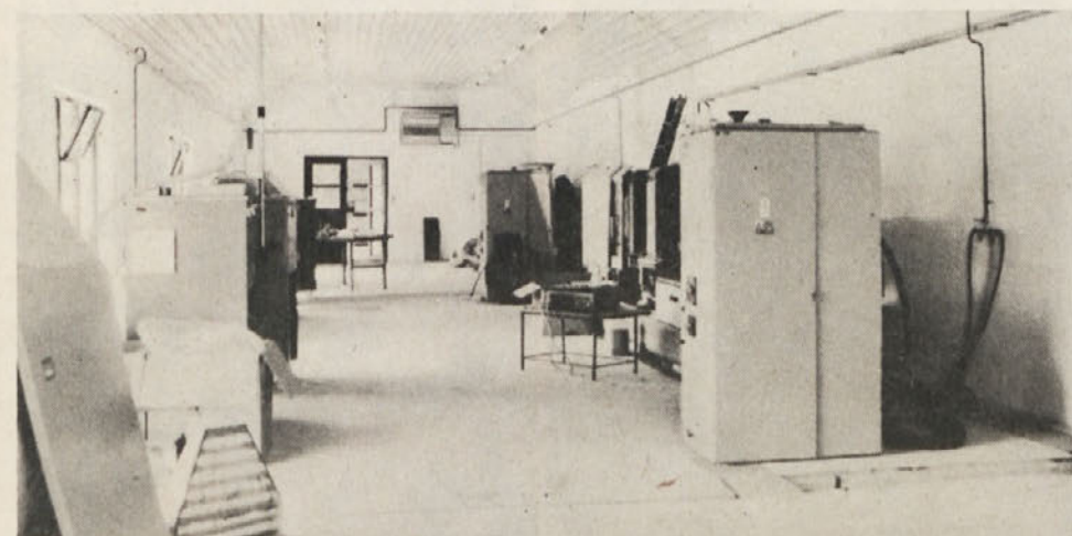
Proizvodni prostor v katerem bo v teh dneh stekla proizvodnja plastičnih delov za tako zahteven trg kot je zahodnonemška avtomobilna industrija. Kljub temu da sta v prostoru že postavljena dva velika stroja za brizganje plastike (500 ton zapiralne sile), ju je vsa dodatna oprema, ki bo priključena in omogočala kakovostno delo, popolnoma skrila. Dokaz, da samo stroj še ni dovolj.
