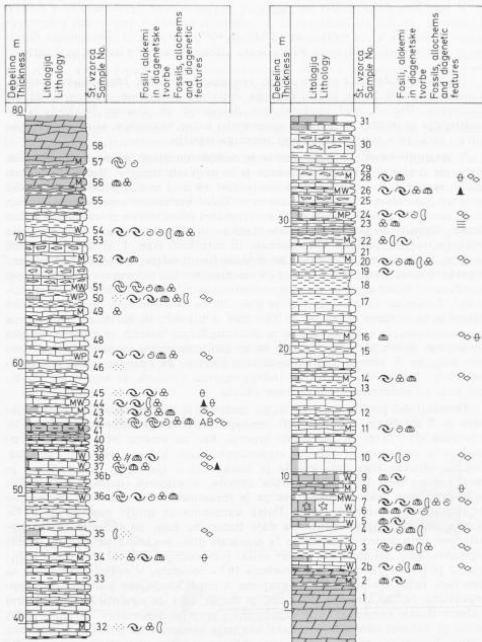
Sl. 5. Litostratigrafsko zaporedje karnijskih plasti v profilu Črna voda nad Tamarjem
