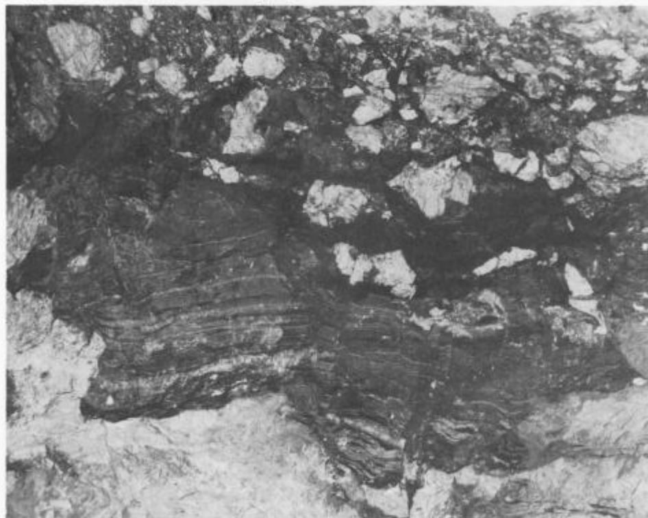
Sl. 10. Zapolnitev lijakaste kraške vdolbine v grebenskem apnencu z rudnim sedimentom (ritmitom dolomita in sfalerita), na njem breča z glineno-lapornim vezivom. Slika je obrnjena v primarno horizontalno lego. V jami, t. j. v grabenskem revirju na 12. obzorju, je rudni sediment v navpičnem, delno celo v inverznem položaju
