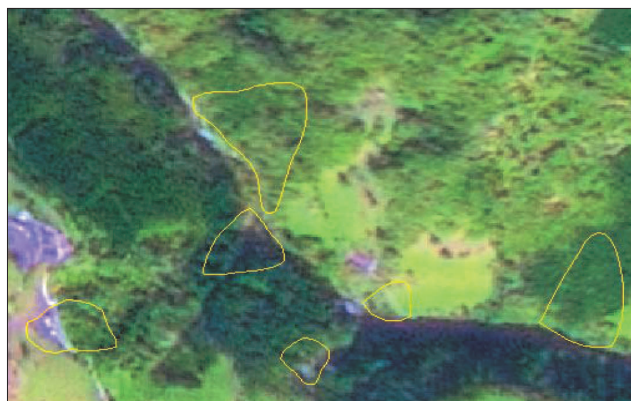
Slika 10. Na izostrenem (pansharpened) satelitskem posnetku SPOT, je označen tip plazov 2, ki predstavlja gibanje plazine s prekinitvami.
