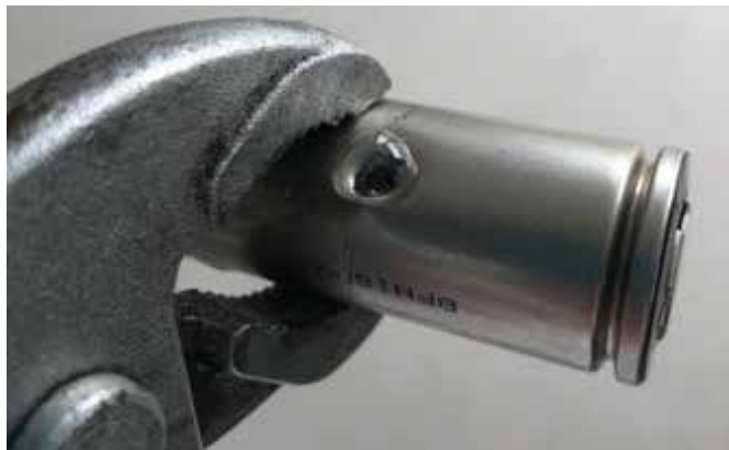
Slika 4: Prikaz vboodne poškodbe na celici Energig 26650
