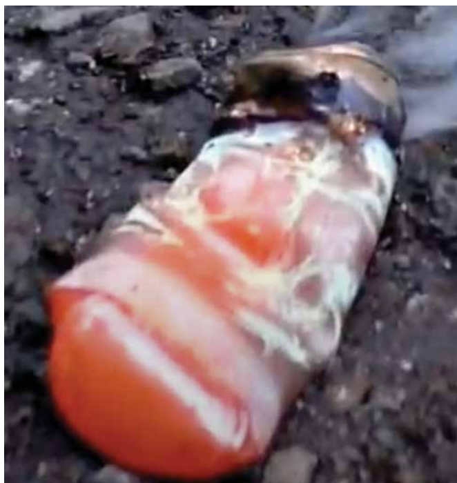
Slika 5: Uničena 18650 celica po toplotnem pobegu
