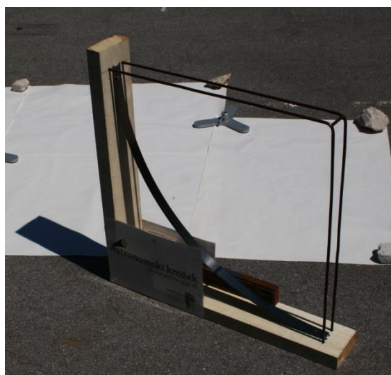
Slika 2, višino mer za merjenje kota \alpha
