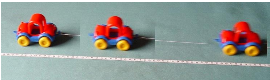
Slika 10: Zlepek treh fotografij. Avto se giblje po vodoravni podlagi. Pri počasnem avtomobilčku je slika ostra, pri hitrem pa ne. Na zadnji fotografiji je bila slika avtomobilčka nejasna, pomeni, da se je na začetku gibal počasneje, na koncu pa hitreje.
