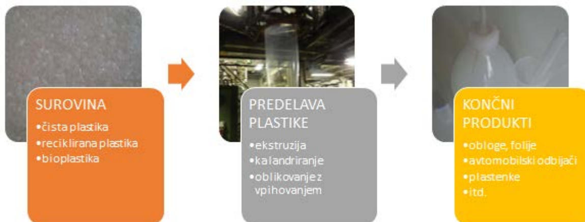
Slika 1: Shema proizvodnje plastičnih izdelkov. V tem industrijskem obratu reciklirajo PE folije, proizvajajo pa PET, HDPE in LDPE folije ter plastenke.
