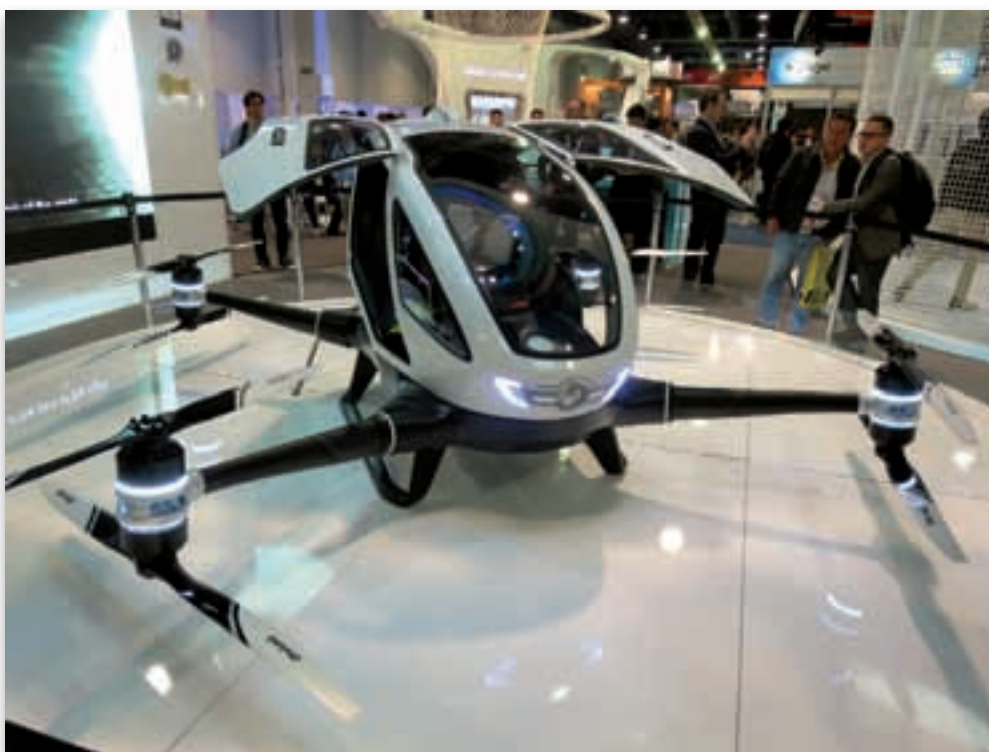
◁ Letalnik Ehang 184 lahko pelje celo človeka (a ga ta ne more upravljati iz kabine).
