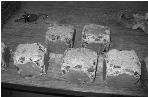
Figure 1: GPC samples after 180 d in sulphuric acid Slika 1: Vzorci GPC po 180 dneih v žvepleni kislini
