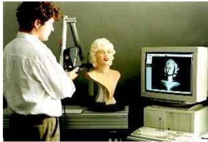
Slika 2: 3D-skener s črnim načinom in ročnim upravljanjem (Edl idr., 2018)
