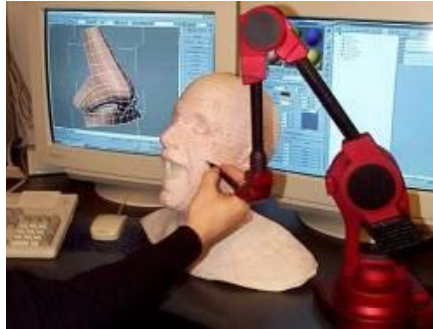
Slika 4: Kontaktno 3D-skeniranje z ročnim vodenjem sonde (ghost3d.com, b. d.)
