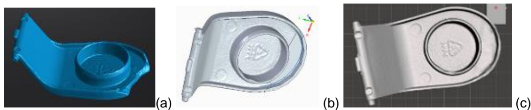
Slika 29: (a) 3D-model polomljenega pokrovčka, (b) njegovo urejanje v programu Solid Edge in (c) glajenje v programu Meshmixer
