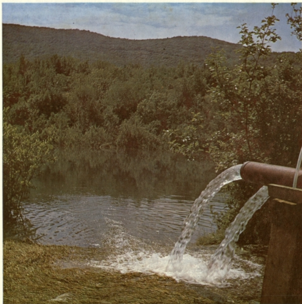
Fig. 15. Essai par pompage sur le forage VB-4/81. Débit 55 l/s Sl. 15. Črpalni poizkus v vodnjaku VB-4/81 s pretokom Q = 55 l/s
