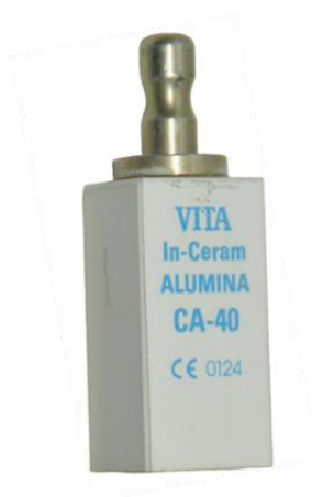
Slika 76: Blok keramike In-Ceram Alumina CAD/CAM (lastni vir).
