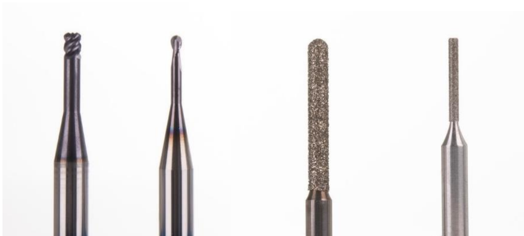
Slika 4: Orodja za rezkanje in brušenje (vir: Interdent).
