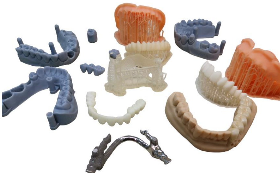
Slika 64: Primeri izdelkov, narejenih z dodajalnimi tehnologijami (lastni vir).
