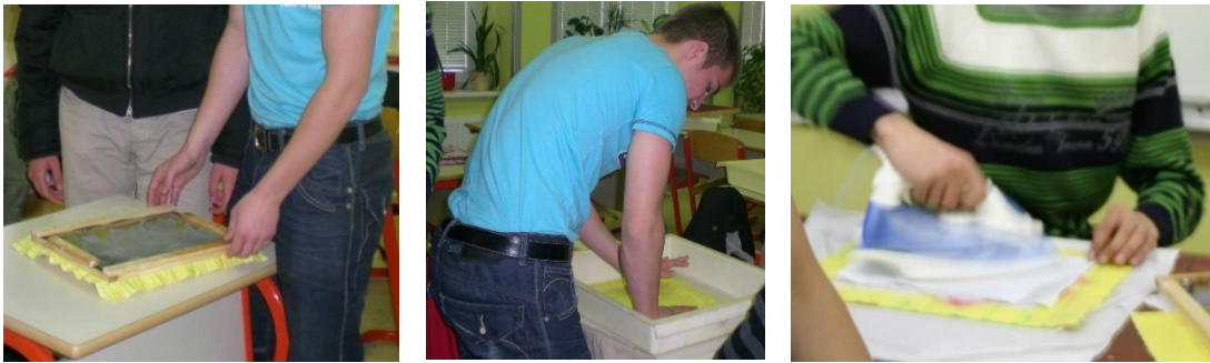
Slika 5: Zvrčanje mase z mreže na krpo (levo), ožemanje (sredina), ožemanje in likanje (desno)
