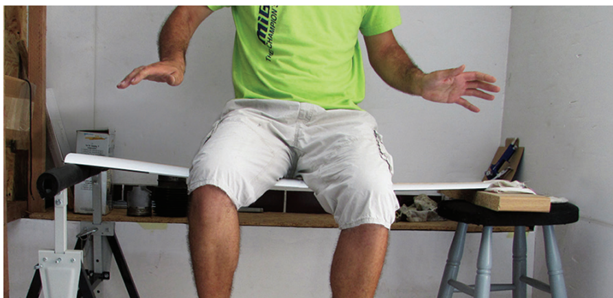
Nekonvencionalni preizkus trdnosti krila
