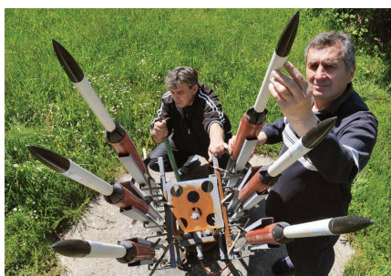
Pogled na lansirno napravo, na katero je mogoče namestiti šest raket PP-8. (Vir: internet)
