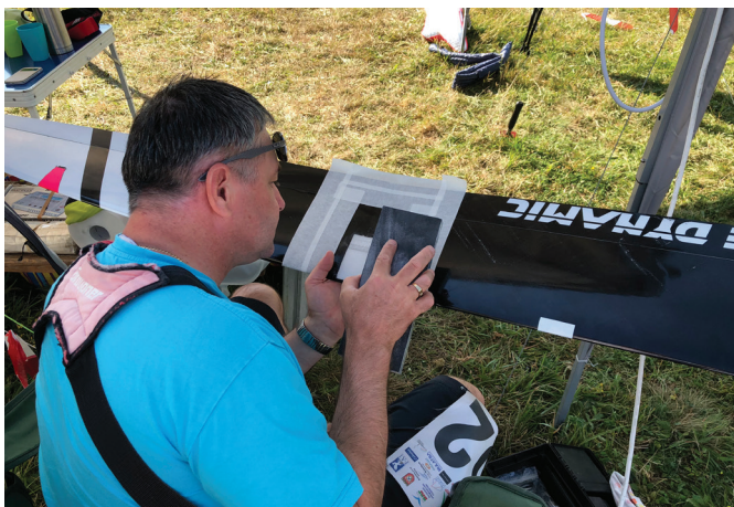
Bojan popravlja poškodbo krila po trku z drugim modelom v zraku.
