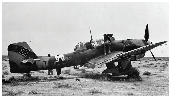
Pozni Ju 87R-2 v Afriki; v zadnjem delu zasteklitve se vidi dodatni oklep pod šipo
