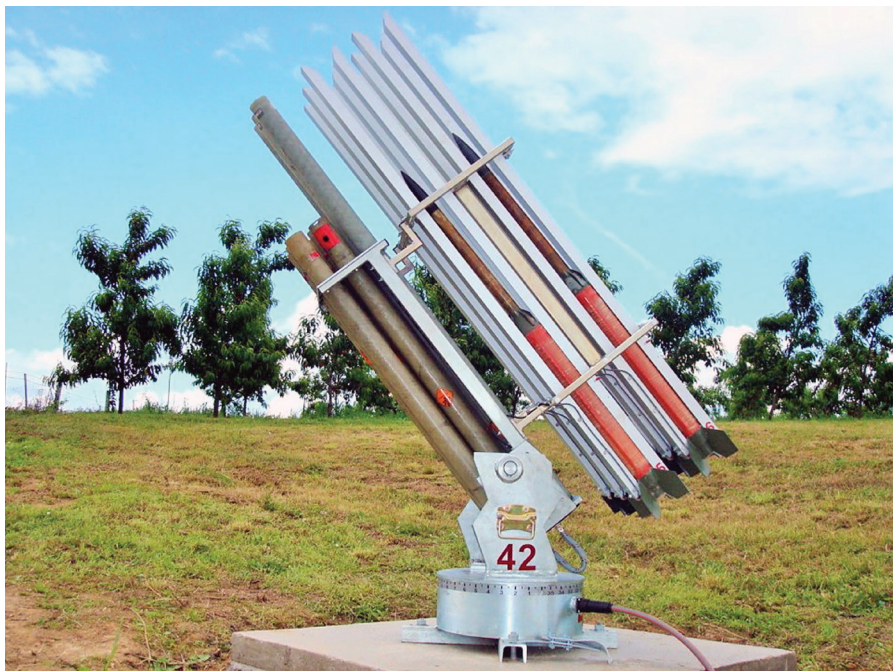
Izstrelitveno mesto z lanserjem za izstreljevanje protitočnih raket, ki omogoča nastavitve kotov po azimutu in elevaciji. (Vir: internet)
