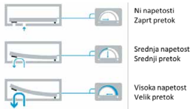
Slika 3: Delovanje proporcionalnega 2/2-potnega ventila VEAE s piezo tehnologijo
