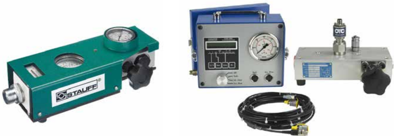
Slika 1: Tokovni tester – merilnik pretoka: a) mehanski (Stauff) in b) digitalni (OTC)
