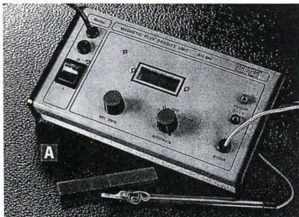
Slika 3. Hallov merilnik gostote magnetnega polja, ki ga izdeluje Unilab. Ima tri območja, in sicer od 0 do 19,99 mT, od 0 do 199,9 mT in od 0 do 1999 mT, to je približno 2 T. S potenciometrom je mogoče naravnati ničlo. Zemeljsko magnetno polje zajamemo z najboljčutljivejšim območjem.
