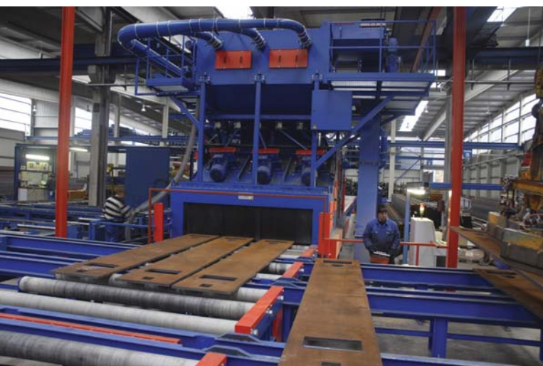
Peskalno sredstvo meče na kose skupno šest turbin z visoko zmogljivostjo tipa Hurricane® H 42, s premerom 420 mm in močjo 22 kW. Z visoko intenzivnostjo peskanja zanesljivo dosegamo stopnjo čistosti pri SA 2,5, ki je vedno ponovljiva in gospodarna. (Foto: Rösler Oberflächentechnik GmbH).
