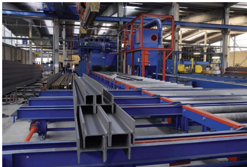
Prečni transporter pri izhodu iz peskalne naprave omogoča enostavno šaržiranje in vezanje peskanih delov z jeklenimi trakovi. (Foto: Rösler Oberflächentechnik GmbH).
