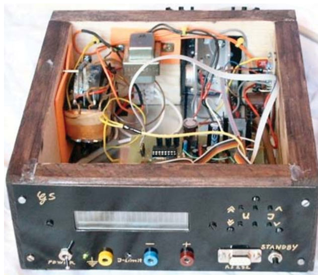
Varčevanje z energijo: sodobni sistem za napajanje računalnika z enosmernim tokom
