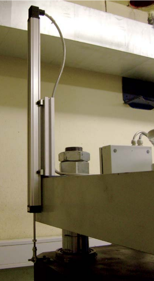
Slika 3: Merilnik pomika, s katerim krmilnik odčitava položaj paha stiskalnice
