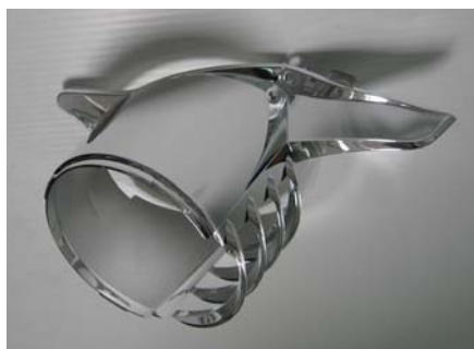
Slika 6: Obroč SS (površina je dodatno obdelana z naparevanjem aluminija)
