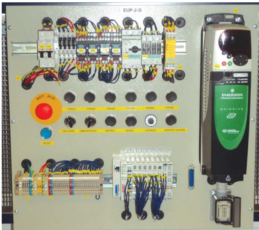
Slika 3: EUP-2 za naprednejše vaje iz regulacije asinhronih motorjev in servomotorjev
