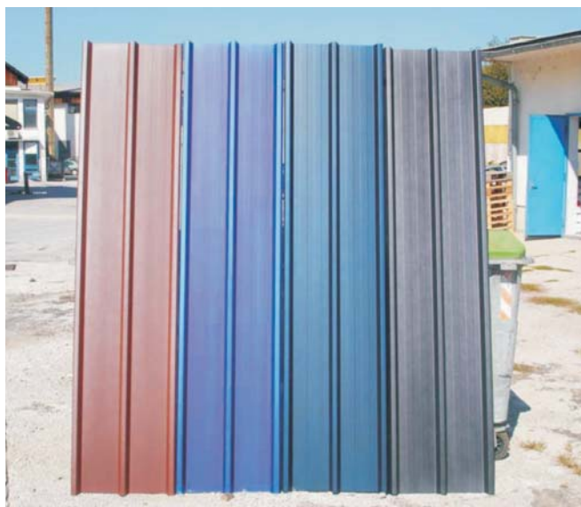
Paneli za sončne zbiralnike, ki so jih izdelali v Laboratoriju za spektroskopijo materialov Kemijskega inštituta v Ljubljani v okviru projekta SEONES za za Trimo, d. d., iz Trebnjega
