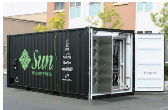
Podatkovni center za kjer koli: ena od izvedb projekta Blackbox podjetja Sun Microsystems
