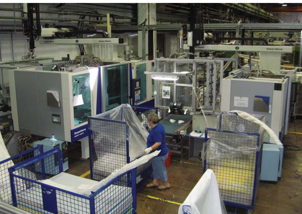
Slika 4: Proizvodnja estetskih sestavnih delov po postopku injekcijskega brizganja
