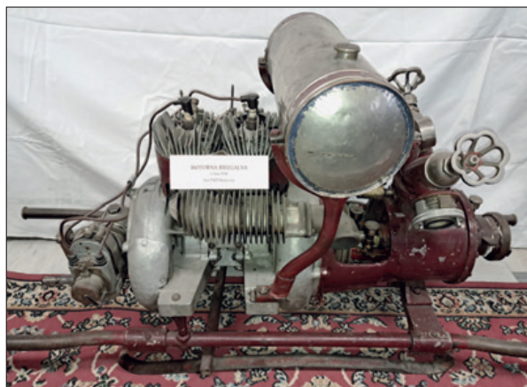
Društvena motorna brizgalna ILO, slovenske izdelave, iz leta 1938, danes eksponat v Gasilskem muzeju Dravinjske doline
