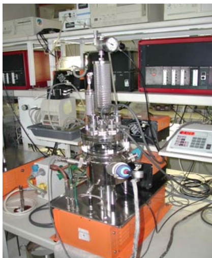
Slika 15. Laboratorijski bioreaktorski sistem ( V_d = 2,5 \text{ dm}^3 )
