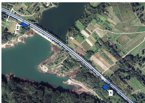
Slika 3: Shema cestne kanalizacije (modre črte) in zadrževalnika meteoritnih vod z lovilci olj (1 in 2) na območju zadrževalnika Vogršček (vir: DOF 2010, GURS; ZK GJL, GURS; izdelava slike: Matjaž Tratnik).
