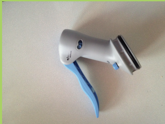
Slika 4. Črpalka je lahko ročna (na sliki), ali pa električna. Namestim jo lahko neposredno na vrh valja ali pa vrh valja s cevjo povežemo s črpalko.
