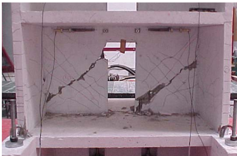
Slika 3.31: Prva etaža pet etažne stenaste konstrukcije, ki je bila preizkušena v okviru projekta ECOLEADER (foto Peter Kante)
