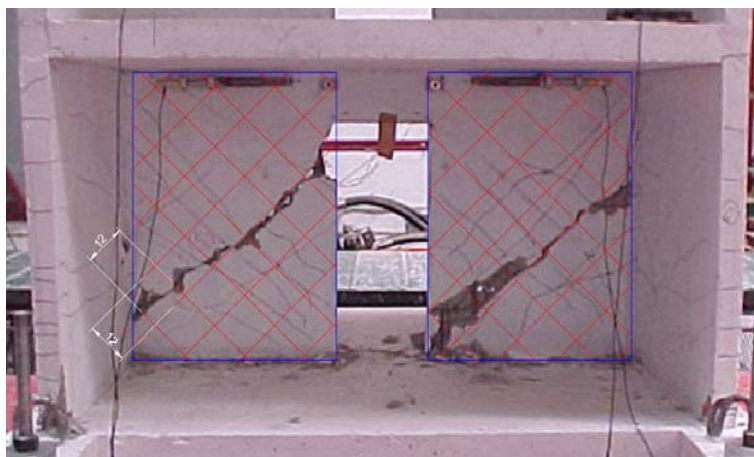
Slika 3.60: Dejanska in po CEB-u izračunana mreža razpok v stojini H stene, ki je bila preizkušena v okviru projekta ECOLEADER (foto Peter Kante)
