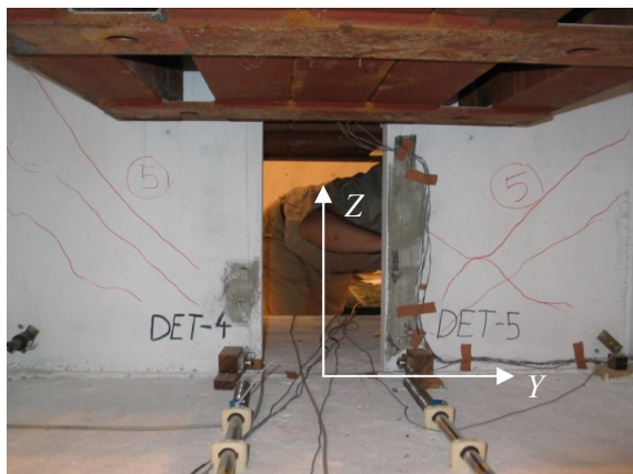
Slika 7.26: Razpoke na stojinah v prvi etaži po peti fazi preizkusa (foto Peter Kante)
