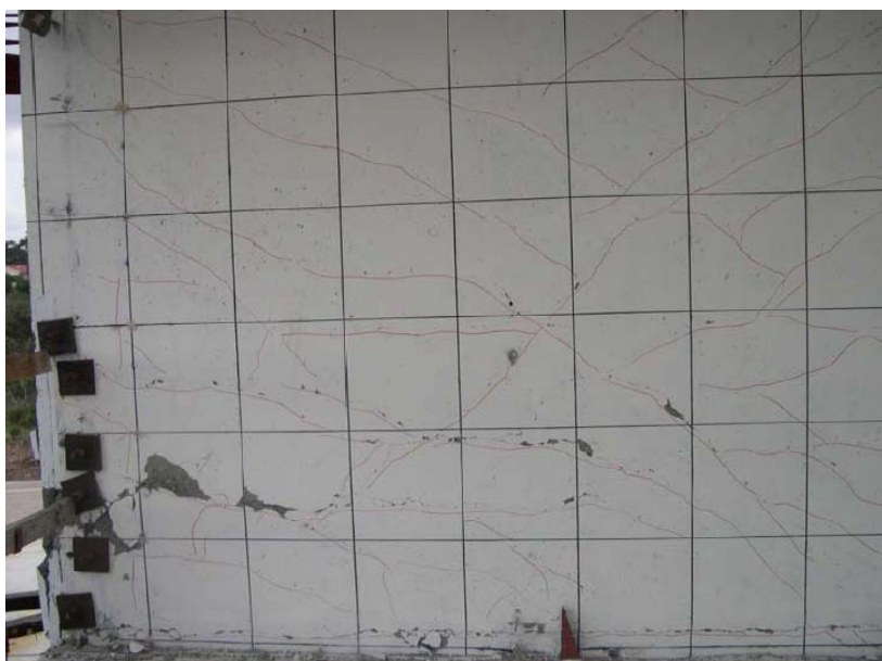
Slika 3.27: Vzorec razpok v prvi etaži več etažne stene, ki je bila preizkušena na UCSD (slika iz Panagiotou et al., 2007b, stran 39)
