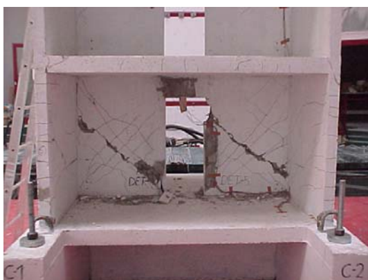
Slika 7.40: Razpoke na stojinah v prvi etaži po šesti fazi preizkusa (foto Peter Kante)
