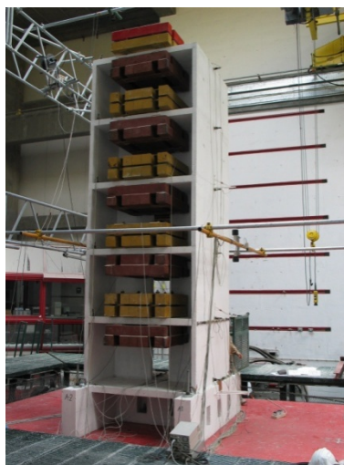
Slika 7.1: Model pet etažne prostorske stene, ki je bila preizkušena v LNEC laboratoriju v Lizboni (foto Peter Kante)
