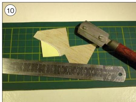
tona ali 1 mm debele balze (slika 10). Robove stabilizatorjev poravnamo in obrusimo (slika 11). Njihov položaj na vsakih 120° označimo s pomočjo šablone - traku, ki ga ovijemo okoli trupa, obseg natančno razdelimo na tretjine in oznake podaljšamo na trup (slika 12).
