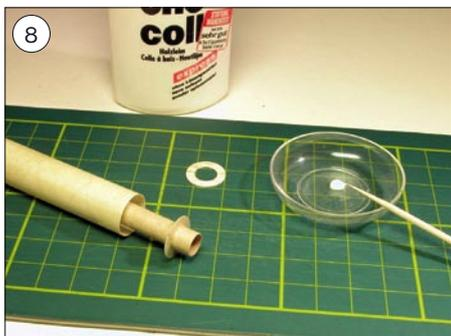
trup z vrha vlepimo še tretji obroček - nosilno pregrado za pristajalni sistem.
