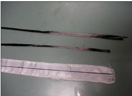
Slika 11. Za ojačitev prednjega roba krila in višinskega stabilizatorja izdelamo trak iz steklene tkanine in ogljikovega rovinga.
