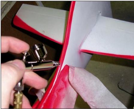
Slika 24. Zračni čopič (airbrush) omogoča enakomeren in natančen nanos barve.
