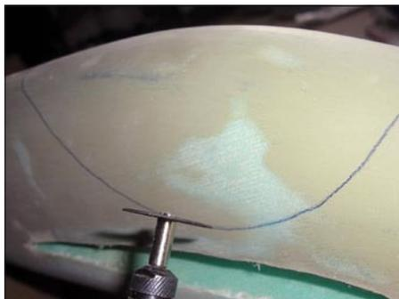
Slika 7. Kabino izrežemo z rezalno ploščico, upeto v miniurtalnik.
