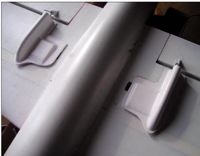
Slika 22. Servomehanizmi so pod pokrovi varni pred poškodbami.
