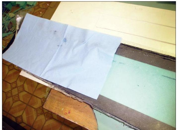
Slika 15. Papirnate brisače so kot nalašč za odstranjevanje odvečne smole.
