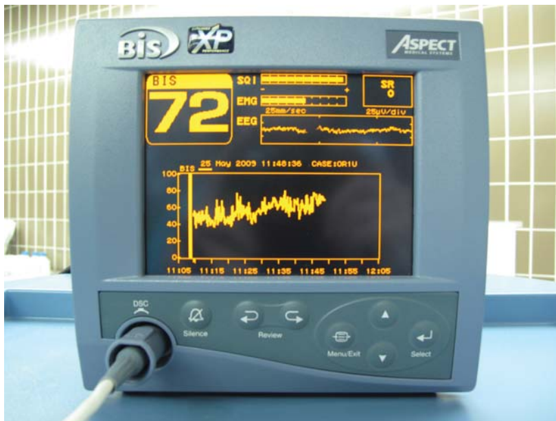
Slika 3: Grafični prikaz merjenih vrednosti na monitorju BIS. Zgornja polovica monitorja: BIS – bispektralni indeks SQI – indeks kakovosti signala, EMG – aktivnost EMG, SR – supression ratio. Spodnja polovica monitorja kaže meritve BIS v času.
