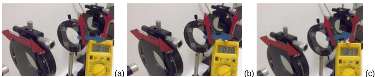
Slika 29: Zaporedje slik pri zasuku lastnih osi folije za kot \alpha . v pozitivno smer a) +5^\circ , b) +10^\circ , c) +15^\circ glede na vodoravno x -os, vzdolž katere je prepustna smer polarizatorja. Prepustna smer analizatorja je pravokotno na polarizator. Intenzitete prepuščene svetlobe so a) 0,016 V, b) 0,038 V in c) 0,071 V (Urankar, 2016).
