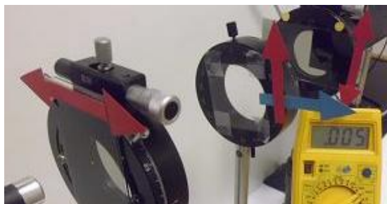
Slika 28: Intenziteta prepuščene svetlobe je 5 mV pri kotu \alpha = +99^\circ glede na izbrani laboratorijski sistem, ko sta smeri obeh lastnih osi v foliji poravnani s prekrižanima prepustnima smerema polarizatorjev (Urankar, 2016).
