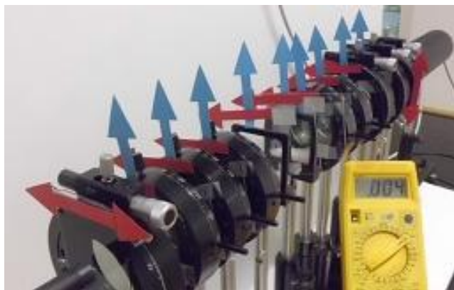
Slika 31: Z lasersko svetlobo posvetimo na devet folij, ki imajo počasne osi, vzporedne s prepustno smerjo polarizatorja in hkrati prekrižane s prepustno smerjo analizatorja. Izmerjena intenziteta prepuščene svetlobe je 0,004 V tako za zeleno kot rdečo svetlobo (Urankar, 2016).
