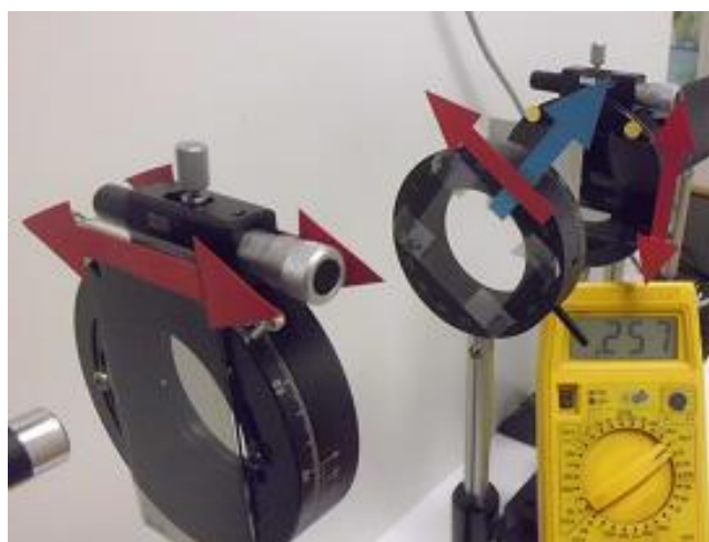
Slika 13: Intenziteta prepuščene svetlobe (0,275 V) je največja, ko sta lastni osi folije pod kotom 45^\circ glede na prepustno smer polarizatorja (Urankar, 2016).
