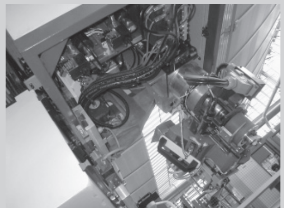
□ Slika 4, Obdelovalna glava s agregati za izdelavo foldinga
