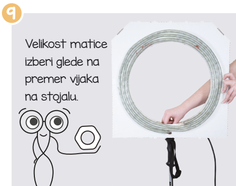
9. KORAK: LED obroč namesti na stojalo in pritrdi z matico.
