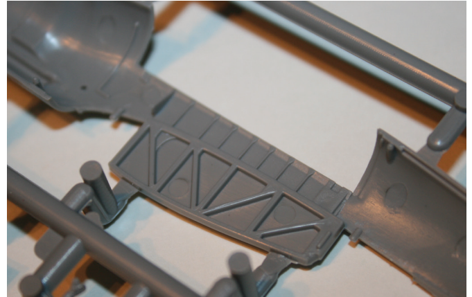
Na notranji strani motorskih gondol so vidni ostanki izmetačev kapa, ki jih je treba odbrusiti.
