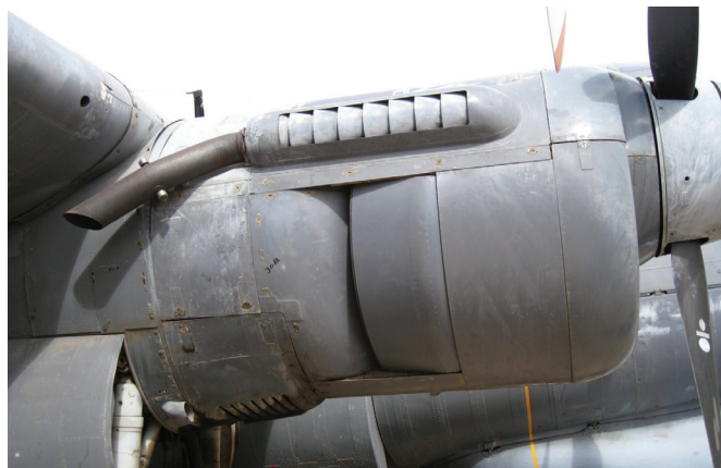
Motorska gondola z značilnim izpušnim sistemom
