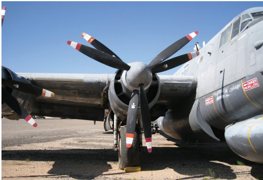
Na fotografiji so dobro vidni krajši notranji kraki propelerja, ki jih je na maketi treba skrajšati za 1 mm.
