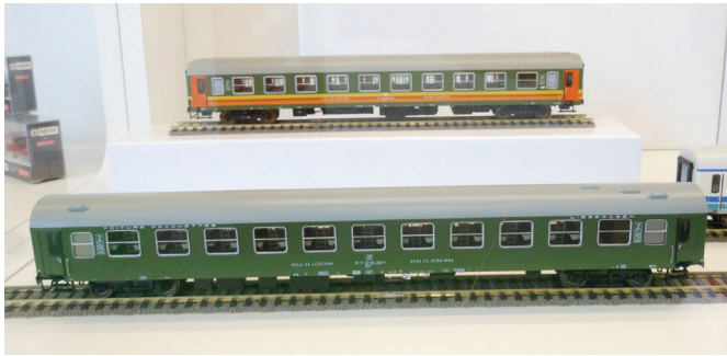
Za naše ljubitelje malih železnic bosta posebej zanimiva ACME-jeva modela vagonov ležalnikov JŽ v merilu 1 : 87. Prvi ležalnik v oranžno-rumeno-zeleni barvi je 2r tip Y, drugi v zeleni barvi pa je 2r tip Bcom.
