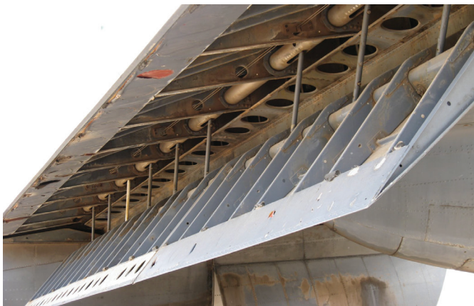
Struktura glavnih zakrilc na krilu
