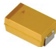
Oznaka na tantalnem kondenzatorju. Črta označuje pozitiven priključek (tudi če znak + ni izpisan).
