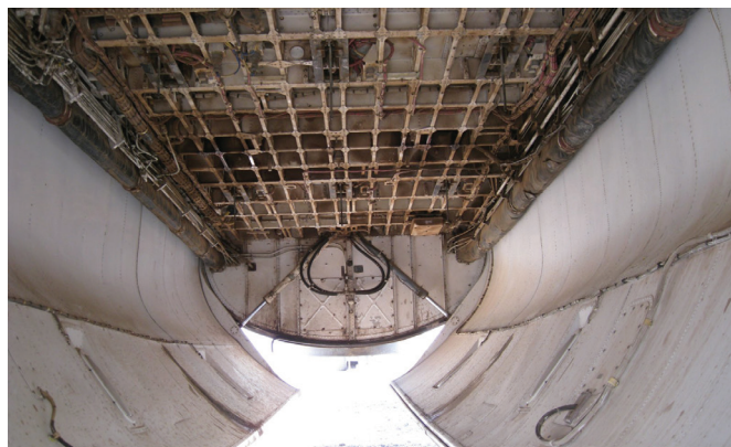
Notranjost bombnega jaška
