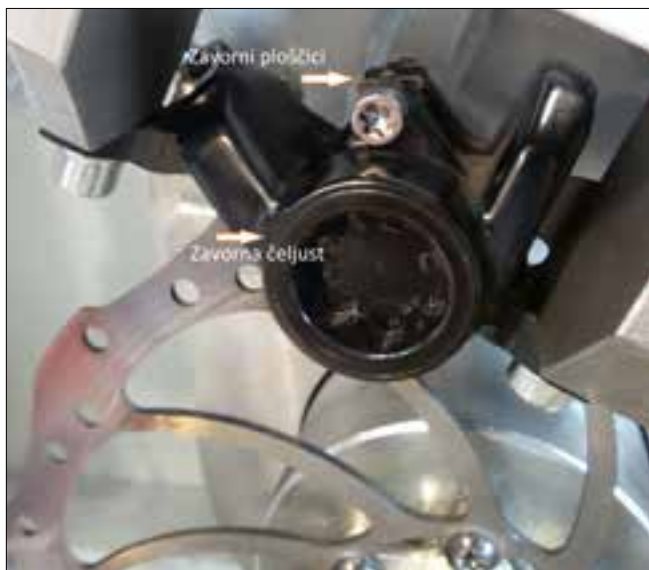
Slika 2. Zavorni sistem kolesa z diskom [1]
