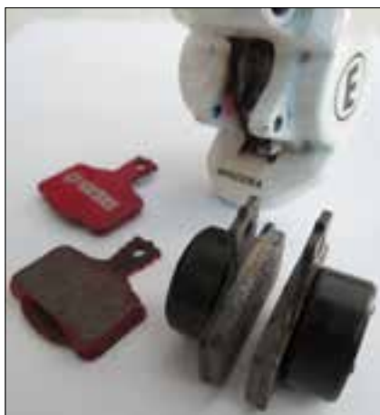
Slika 1. Zavorna čeljust in zavorne ploščice. Na dveh sta nameščena zavorna batka iz čeljusti [1]
