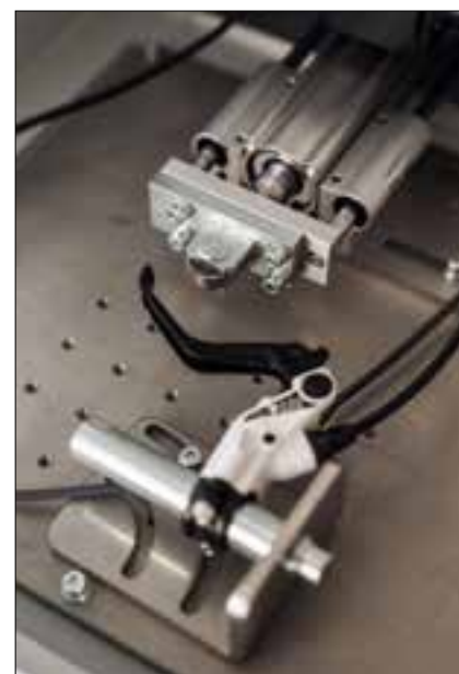
Slika 4. Linearni aktuator lahko pritiska na zavorno ročico s konstantno ali spremenljivo silo [1]
